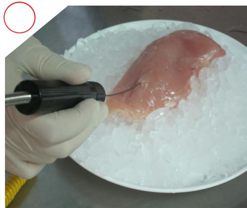
將金屬探針插入食材最厚的部分檢測溫度
