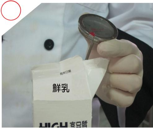
將溫度計探針插入食品中檢測溫度
