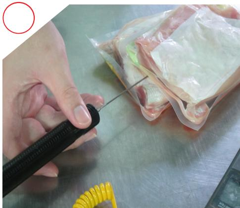
將溫度計插入兩包裝間檢測溫度
