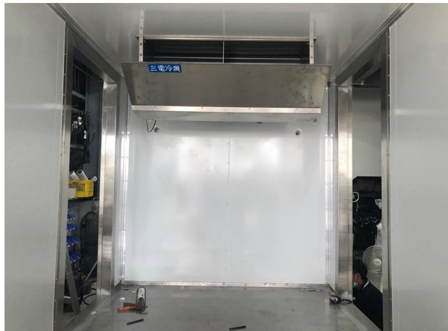
！不用啟動引擎，使用插電系統預冷，可以節能減碳
