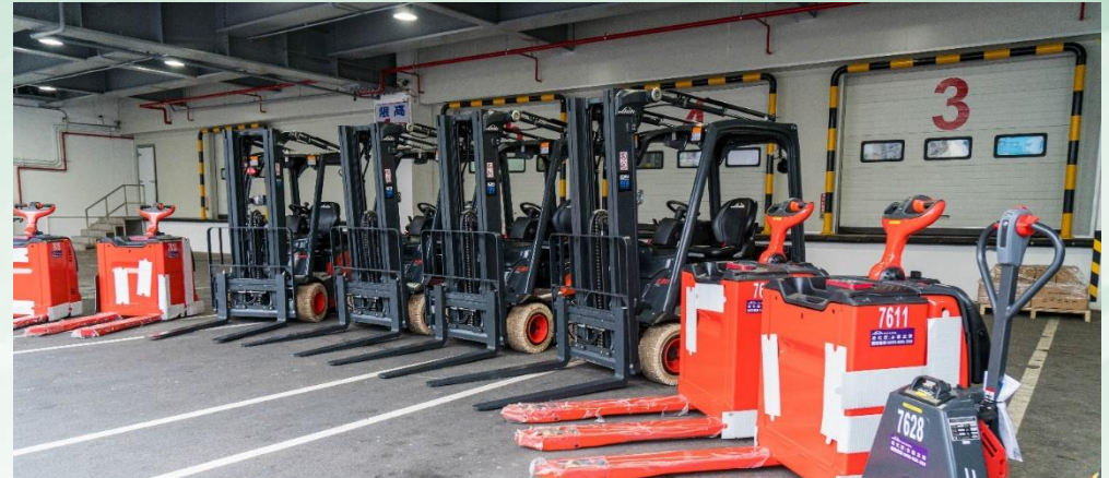
購置堆高機、拖板車 便利推動棧板化作業
