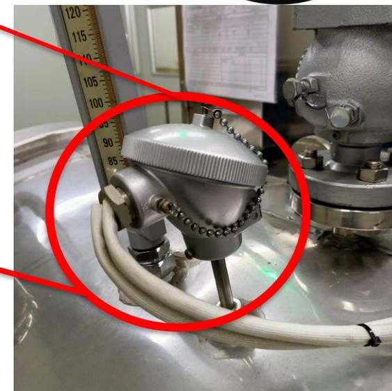
電子式溫度計(於感溫處安裝熱電偶感溫棒)
