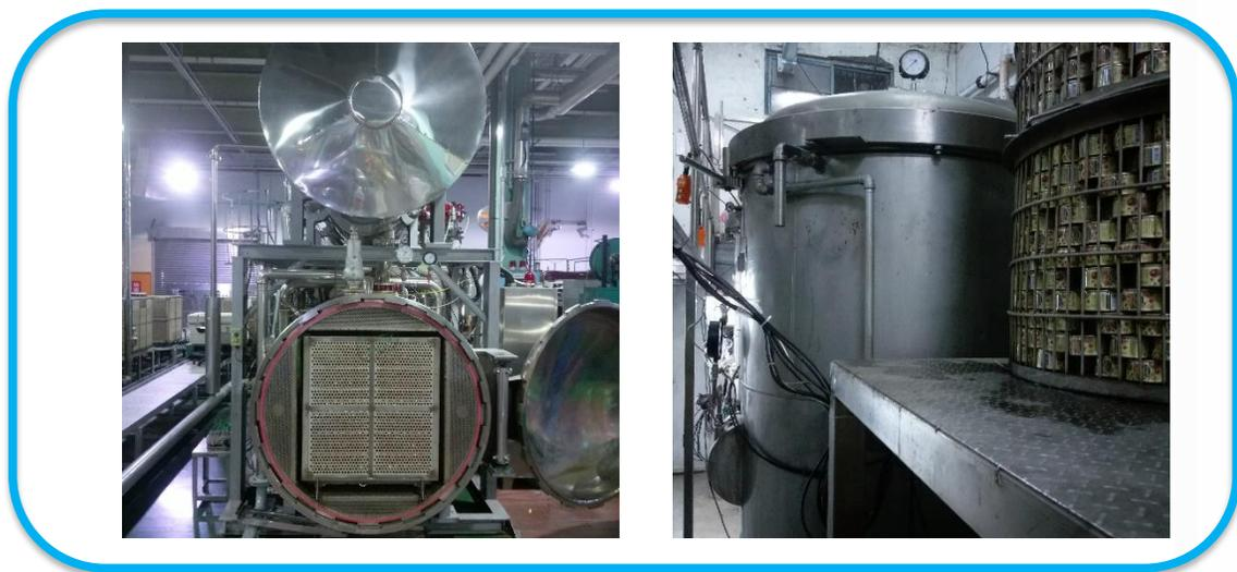
圖左、子母式殺菌釜；圖右、立式殺菌釜
