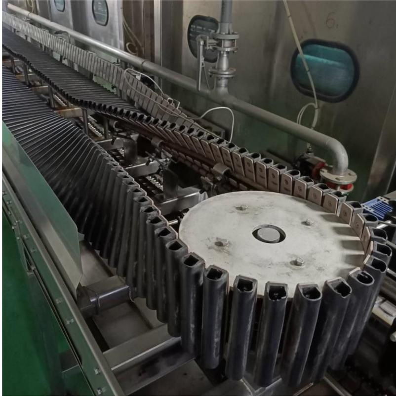
封裝後產品倒瓶機構
