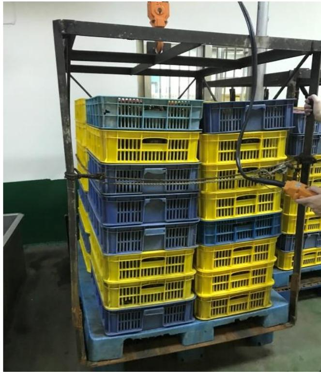
多以吊掛方式放入熱水中，其加熱溫度多在85°C至99°C之間，常見溫度偏差約在 $\pm 3^{\circ}\text{C}$ 。
