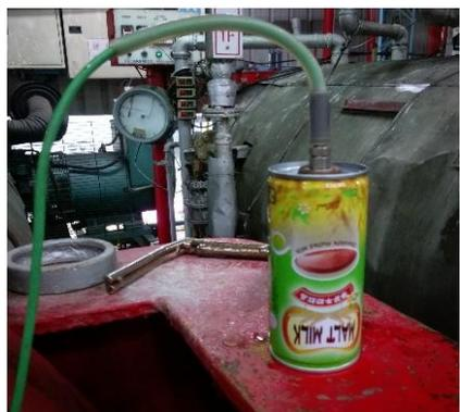
蒸汽式殺菌釜於 $100^{\circ}\text{C}$ 以下溫度浮動較大，建議以排氣溫度( $105^{\circ}\text{C}$ 以上)達到後，計算殺菌時間。
