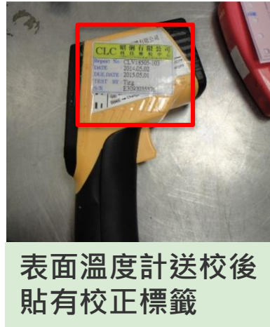
中心溫度計送校後貼有校正標籤
