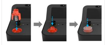
系統將自動進入檢體去活性化流程並進行倒數·過程中請勿移動檢體杯,此步驟結束時螢幕和提示音會提醒您「加熱和冷卻流程結束」,並自動進入下一步說明畫面。
