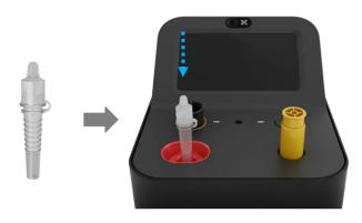
取出檢體杯,確認白色試劑球在檢體杯底部
