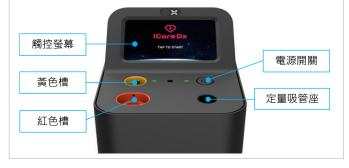
將分析儀連接電源後長按電源開關 3 秒開啟·請選擇一個可用的 Wi-Fi 網路推行連接。
