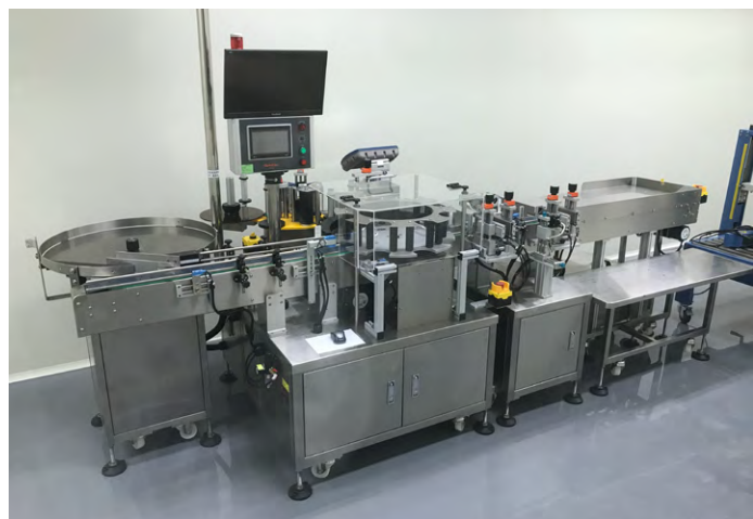
圖4-2 溶液劑產線設備圖－自動圓瓶貼標機
