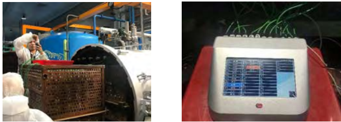
圖 7、殺菌釜熱分佈實際測試設備及情形
