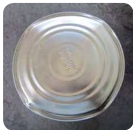
圖 3、加壓冷卻異常致罐頭變形
