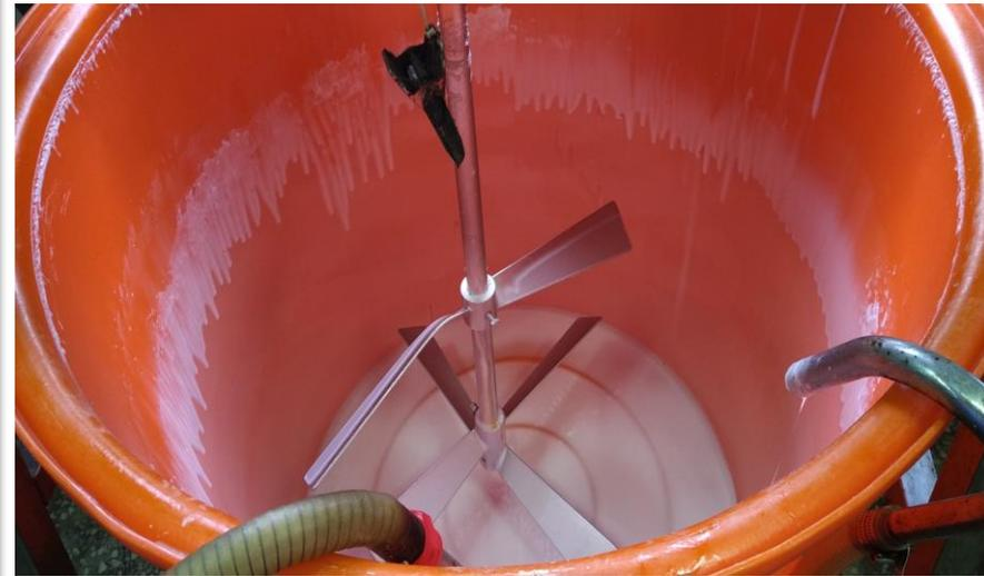
容器應採用與產品、清潔劑及消毒劑相容之材質，挑選時需考量產品配方、製程、清潔及消毒方法等，依需求選擇具耐熱性、抗腐蝕性、耐磨性、表面光滑及易於清潔、消毒與維護之材質，製程操作應優先考量使用具有足夠理化強度與耐受性之不鏽鋼（如304或316）容器，半成品儲存則可考量使用不鏽鋼或符合要求之塑膠材質。
