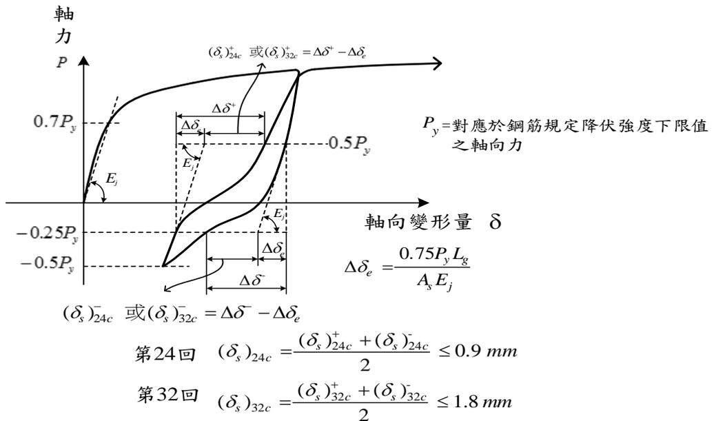
圖五 當次滑動量計算法示意圖
