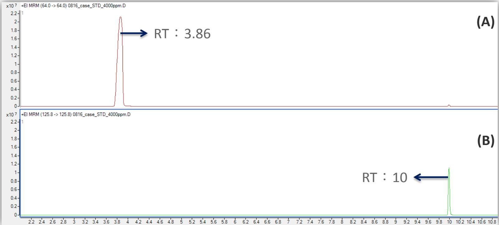
圖一、(A)二氧化硫標準品層析圖(B) 2-氯甲苯層析圖。
