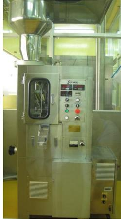
本廠現有打錠機及錠模為鎮江機器廠股份有限公司製造，機型為 JC-RT-24H，打錠後之錠片品質穩定，廠商提供之自動快速膜衣機，膜衣厚度須符合驗收規格。
