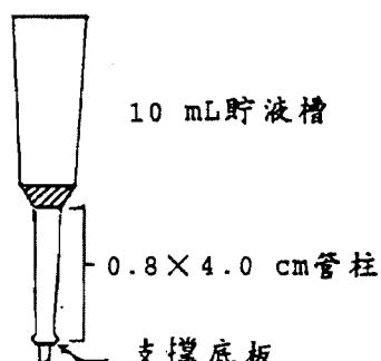
2.3.6. 砂膠淨化管柱之製備：將粒徑0.04~0.063 mm之砂膠60以105°C烘乾1小時，取出置乾燥器中冷卻後，加入佔砂膠重量百分之一的水，置密閉容器內平衡一夜後備用。
