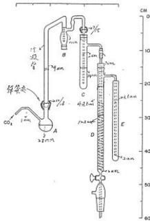
圓底燒瓶 A：具  $\text{CO}_2$  之毛細管入口，以冷凝管與 B 相連。
