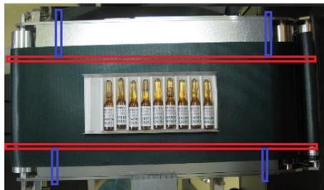
8. 機台高度可調整(750±20mm)且需配合自動裝盒機之進料高度(900mm)。
