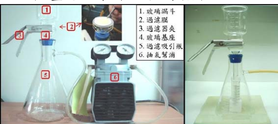
圖二、水檢體過濾裝置 圖三、檢液收集裝置
