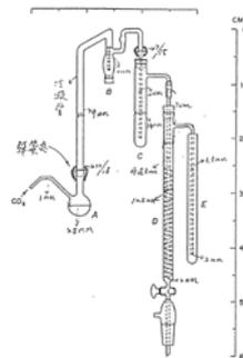
圓底燒瓶 A：具 CO<sub>2</sub> 之毛細管入口，以冷凝管與 B 相連。
