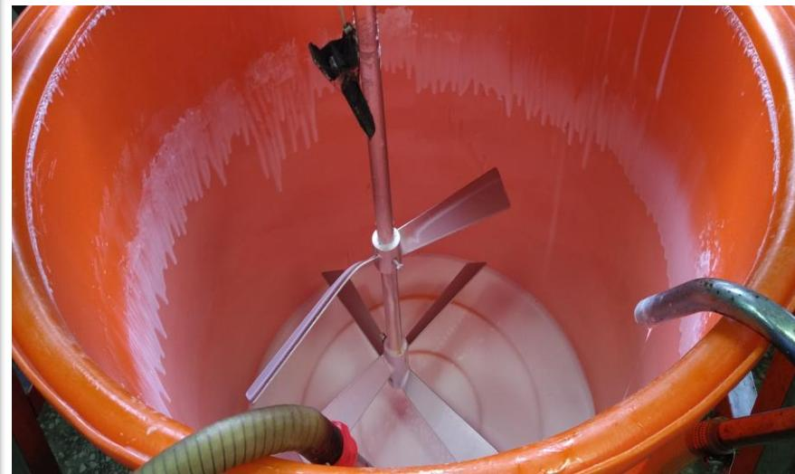
容器應採用與產品、清潔劑及消毒劑相容之材質，挑選時需考量產品配方、製程、清潔及消毒方法等，依需求選擇具耐熱性、抗腐蝕性、耐磨性、表面光滑及易於清潔、消毒與維護之材質，製程操作應優先考量使用具有足夠理化強度與耐受性之不鏽鋼（如304或316）容器，半成品儲存則可考量使用不鏽鋼或符合要求之塑膠材質。
