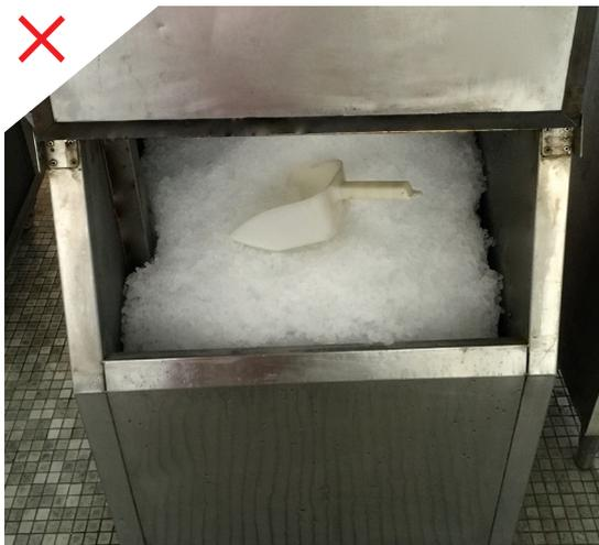
用後冰鏟仍放置在製冰機中
