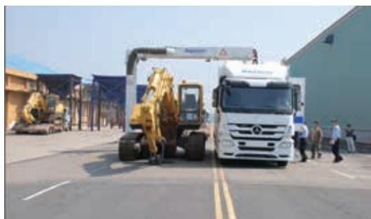
圖7-5 運用機動式貨櫃檢查儀提升查緝效率
